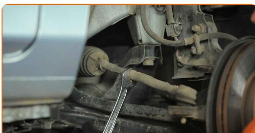
**13** Desaparafuse a extremidade da barra de direção.
