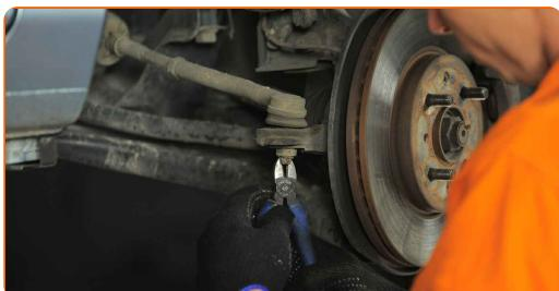
**8** Limpe o elemento de fixação que conecta o terminal de direção à manga de eixo. Use uma escova metálica. Use spray WD-40.
