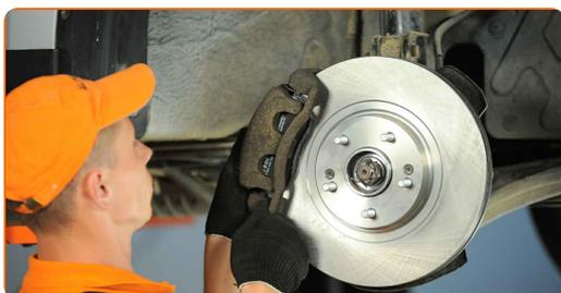
**37** Aperte a braçadeira da pinça do travão. Use uma chave combinada nº 17. Use uma chave soquete nº 17. Use uma chave de torque. Aperte-o para o torque de 85 Nm.
