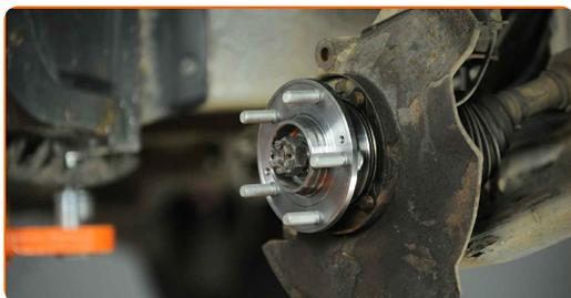
**32** Aperte a porca do cubo de roda. Use uma chave soquete nº 32. Use uma chave de torque. Aperte-o para o torque de 195 Nm.
