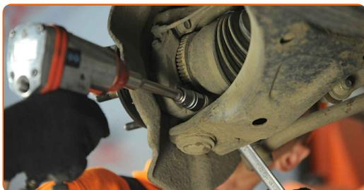
**16** Remova o parafuso de fixação. Use um martelo. Use um saca-pino.
