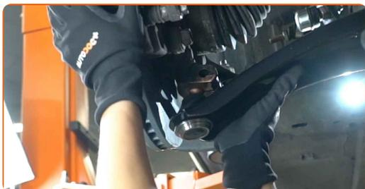
**28** Instale o parafuso de fixação. Use um martelo.
