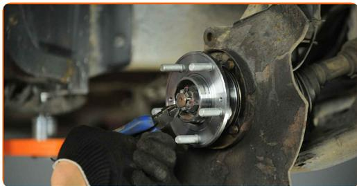
**34** Trate o cubo onde entra em contacto com o disco de travão. Use massa de cobre.
