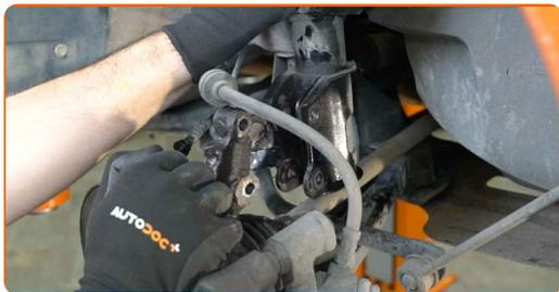
**20** Desapertar a fixação superior de montagem do suporte do amortecedor.
