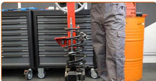
**32** Instale a coifa e o batente de encosto no amortecedor.
