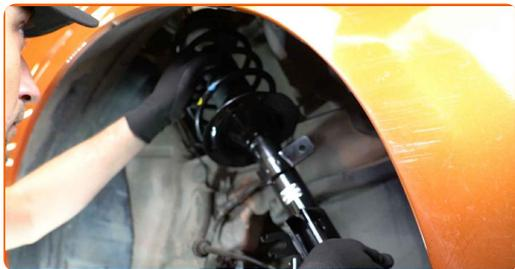
**40** Aparafuse a fixação superior de montagem do suporte do amortecedor. Não o aperte.
