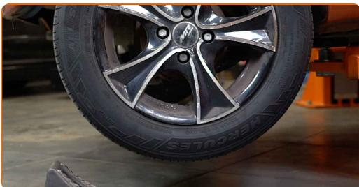
**4** Desaperte os parafusos da roda.
