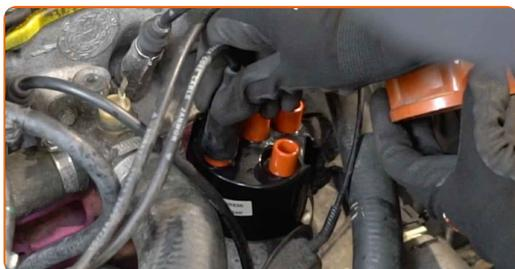
Substituição: rotor do distribuidor – VW Golf 2. AUTODOC recomenda:
