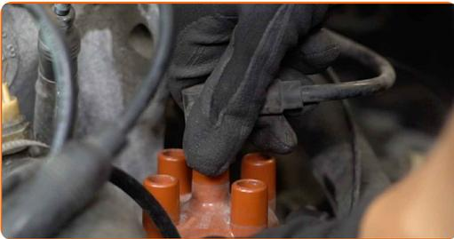
Substituição: rotor do distribuidor – VW Golf 2. Conselho da AUTODOC:
