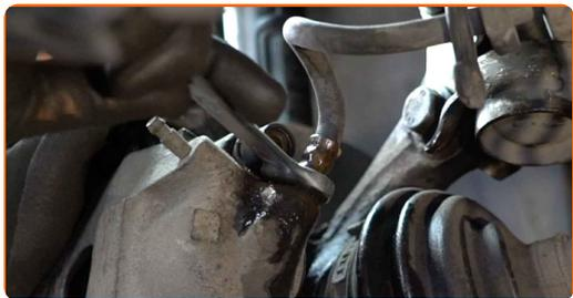
**13** Desaperte o elemento fixador que junta a tubagem do travão à mangueira do travão. Use uma chave combinada nº 11.
