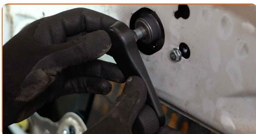
**17** Coloque o mecanismo do regulador da janela na posição totalmente rebaixada.
