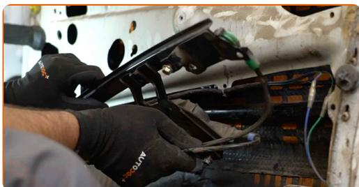
**14** Instale o novo mecanismo regulador da janela.
