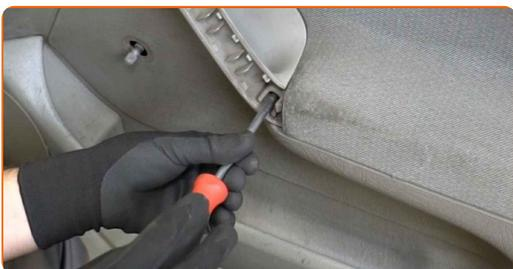
**5** Desmonte a manivela de ajuste do espelho retrovisor.
