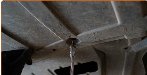
**8** Remova a tampa do cárter de óleo. Use uma chave soquete nº 10. Use uma chave de fenda plana.
