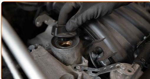
**3** Despeje o fluido de limpeza do motor.
