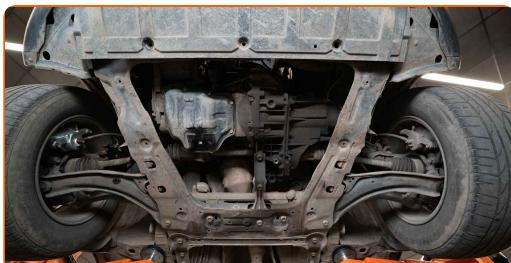
**9** Coloque um recipiente de óleo usado com pelo menos 5 litros de capacidade sob o orifício de drenagem.
