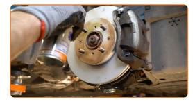
Limpe a superfície do disco de travão. Utilize um produto de limpeza para travões.
