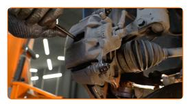
Desaparafuse a fixação de pinça de travão. Use uma chave soquete nº 12. Use uma chave de catraca.
