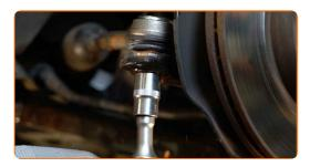
Ao desinstalar, marcar ou medir a posição precisa da articulação esférica na barra de direção, ou contar o número de voltas para evitar posteriormente o desalinhamento. Use um paquímetro.
