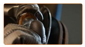
Trate a porca de fixação conectada ao terminal de direção à manga de eixo. Use massa de cobre.
