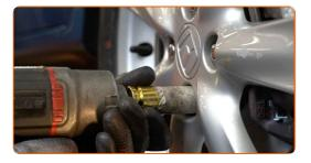
Baixar o carro e trabalhar em ordem transversal, apertar os parafusos das rodas. Use o soquete de impacto para roda #19. Use uma chave de torque. Aperte-o para o torque de 108 Nm.
