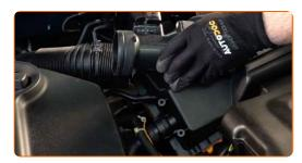
Levante levemente a tampa da caixa do filtro de ar.
