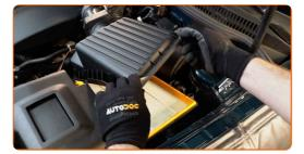
Remova o elemento de filtro a partir da caixa do filtro.
