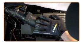
Conecte o tubo de entrada de ar ao compartimento do filtro de ar.
