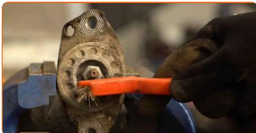
**16** Retire a fixação da haste do pistão do amortecedor. Use uma chave combinada nº 16. Use alicates de pressão.
