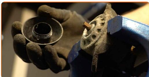
**15** Limpe o elemento de fixação de componentes do amortecedor. Use uma escova metálica. Use spray WD-40.
