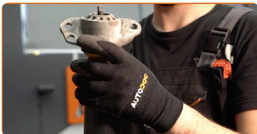
**19** Aperte a fixação superior da haste do amortecedor. Use uma chave combinada nº 16. Use uma chave soquete nº 16. Use uma chave de torque. Aperte-o para o torque de 25 Nm.
