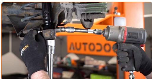
**29** Apertar a fixação superior do amortecedor. Use uma chave combinada nº 16. Use uma chave soquete nº 16. Use uma chave de torque. Aperte-o para o torque de 30 Nm.+90°
