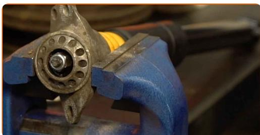
**21** Instale a tampa protetora do suporte do amortecedor.
