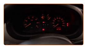
Ligue o motor por alguns minutos. Após a luz de advertência da pressão do óleo se apagar, desligue o motor.
