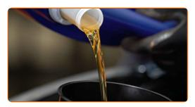
Despeje o óleo no motor através do gargalo de enchimento de óleo. Quantidade necessária de óleo: 3.8 l.
