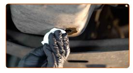
Aparafuse o novo bujão de drenagem e aperte-o. Use a chave quadrada do bujão de drenagem de óleo N.º8. Use uma chave de torque. Aperte-o para o torque de 20 Nm.
