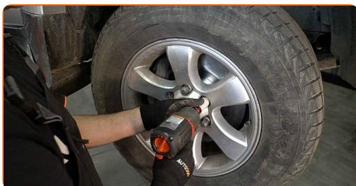
**33** Baixar o carro e trabalhar em ordem transversal, apertar os parafusos das rodas. Use uma chave de torque. Aperte-o para o torque de 112 Nm.
