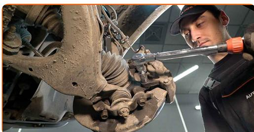
**24** Fixe o suporte de fixação da mangueira do travão. Use uma chave soquete nº 12. Use uma chave de catraca.
