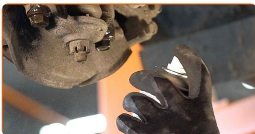
**13** Desaperte a fixação inferior do suporte do amortecedor. Use uma chave soquete nº 19.
