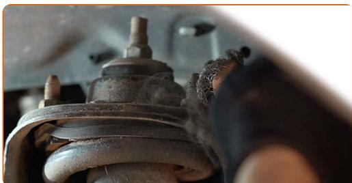
**18** Desaperte a fixação do suporte superior do braço do amortecedor. Use uma chave combinada nº 14. Remova o parafuso de fixação.
