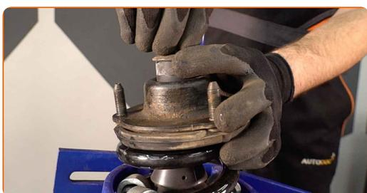
**31** Aperte a porca do suporte do amortecedor da haste do pistão. Use uma chave combinada nº 17. Use uma chave inglesa. Use uma chave de torque. Aperte-o para o torque de 25 Nm.
