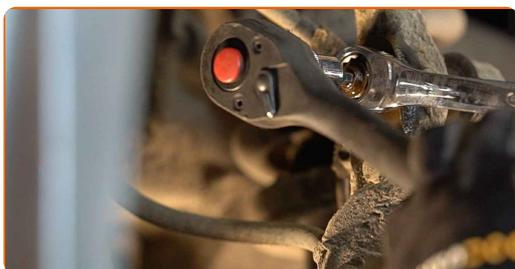
**10** Desaperte os fixadores dos suportes da bucha da barra estabilizadora. Use uma chave soquete nº 14.
