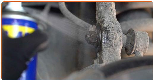
**9** Desaparafuse os fixadores que conectam a bieleta da barra estabilizadora à manga de eixo. Use uma chave soquete nº 17. Use uma chave combinada nº 17. Use HEX n.º H6.
