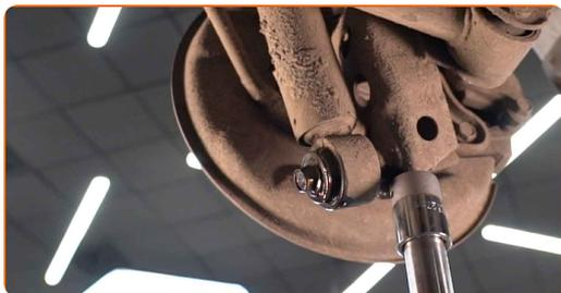
**8** Desaperte a fixação superior do amortecedor. Use uma chave combinada nº 17. Use alicates de pressão.
