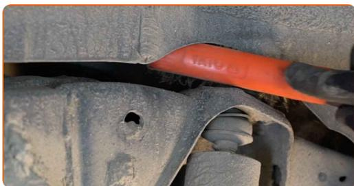
**7** Apoie o eixo de torção da suspensão traseira. Use um macaco hidráulico de caixa de transmissão.
