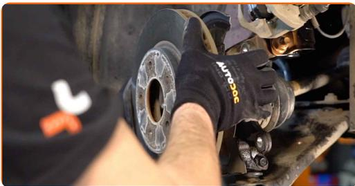
**22** Limpe o cubo. Use uma escova metálica. Trate a superfície de contacto. Use massa de cobre.
