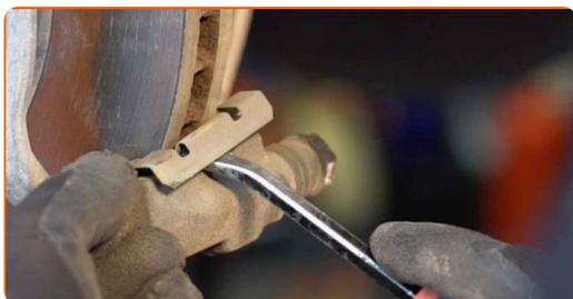
**12** Limpe a braçadeira da pinça de travão de sujidade e poeira. Use uma escova metálica. Utilize um produto de limpeza para travões.
