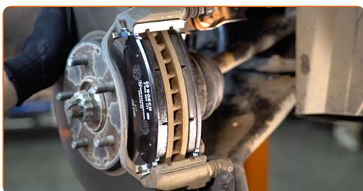
**17** Instale a pinça de travão e fixe-o. Use uma chave combinada nº 17. Use uma chave soquete nº 14. Use uma chave de torque. Aperte-o para o torque de 26 Nm.
