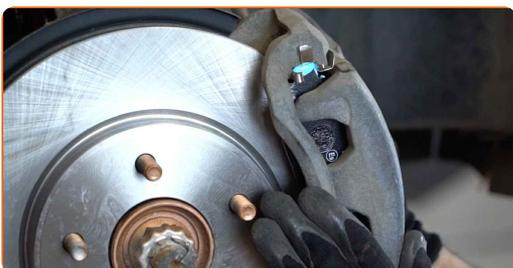
**25** Aperte a braçadeira da pinça do travão. Use uma chave soquete nº 19. Use uma chave de torque. Aperte-o para o torque de 165 Nm.
