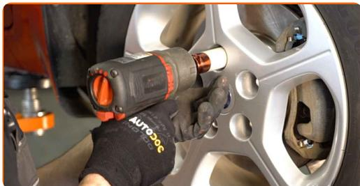
**30** Baixar o carro e trabalhar em ordem transversal, apertar os parafusos das rodas. Use uma chave de torque. Aperte-o para o torque de 108 Nm.
