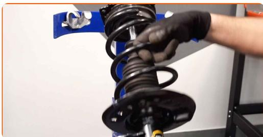
**35** Instale o amortecedor no arco da roda.
