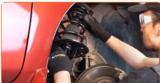
**36** Aparafuse a fixação superior de montagem do suporte do amortecedor. Não o aperte.
