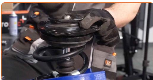
**32** Aperte a porca do suporte do amortecedor da haste do pistão. Use uma chave soquete nº 18. Use HEX n.º H6. Use uma chave de torque. Aperte-o para o torque de 68 Nm.
