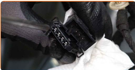
**45** Trate o conector do módulo interruptor do vidro elétrico. Use graxa dielétrica.
