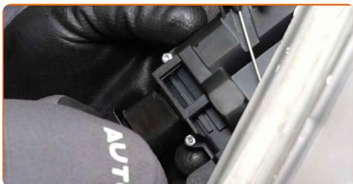
**39** Aparafuse os fixadores do painel da porta. Use uma chave soquete nº 10. Use uma chave de catraca.
