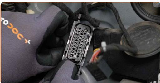
**18** Desmonte a cablagem do vidro elétrico. Use uma ferramenta de remoção de clipe.
