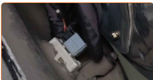
**60** Ligue o conector do módulo interruptor do vidro elétrico.
