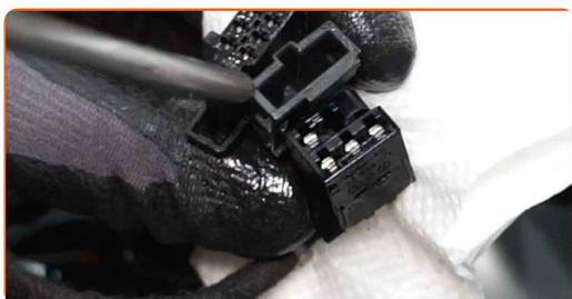
**44** Trate o conector do interruptor do espelho elétrico. Use graxa dielétrica.
