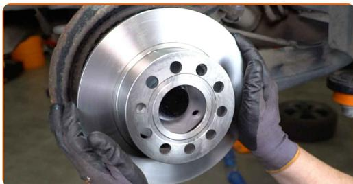
**22** Aperte a fixação do disco de travão. Use Torx T30. Use uma chave de torque. Aperte-o para o torque de 4 Nm.
