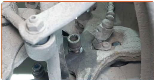
**26** Aperte os parafusos do suporte da pinça do travão. Use XZN #14. Use uma chave de torque. Aperte-o para o torque de 90 Nm.
