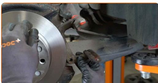
**25** Instale os parafusos de fixação.
