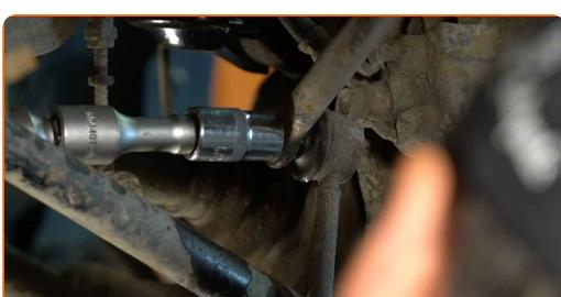
**8** Desaparafuse o fixador que conecta a bieleta da barra estabilizadora à coluna do amortecedor. Use uma chave soquete nº 17. Use uma chave de catraca.
