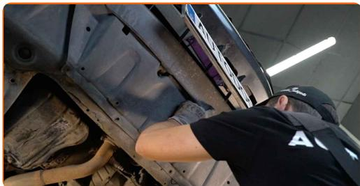
**21** Aperte os fixadores da tampa inferior do cárter. Use uma chave soquete nº 10. Use uma chave de catraca.
