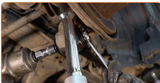
**18** Aperte o fixador que conecta o braço arrastado à carroçaria do automóvel. Use uma chave combinada nº 17. Use uma chave soquete nº 17. Use uma chave de tarraxa.
