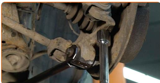
**17** Aparafuse o elemento fixador, que liga o braço de suspensão à manga de eixo traseira. Use uma chave combinada nº 18. Use uma chave soquete nº E18. Use uma chave de tarraxa.
