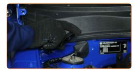
Desapertar a fixação superior de montagem do suporte do amortecedor. Use uma chave combinada nº 21. Use HEX n.º H7. Use uma chave de catraca.
