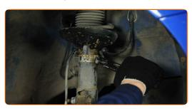
Trate os fixadores do amortecedor. Use massa de cobre.
