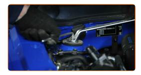
Instale a tampa de proteção de suporte do amortecedor.
