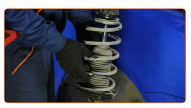
Aparafuse a fixação superior de montagem do suporte do amortecedor.
