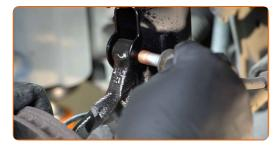
Aperte os fixadores inferiores que conectam a coluna de suspensão à manga de eixo. Use uma chave combinada nº 18. Use uma chave soquete nº 18. Use uma chave de torque. Aperte-o para o torque de 40 Nm.+90°
