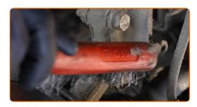
Desaparafuse os fixadores que ligam o suporte de suspensão à manga de eixo. Use uma chave combinada nº 18. Use uma chave soquete nº 18. Use uma chave de catraca.
