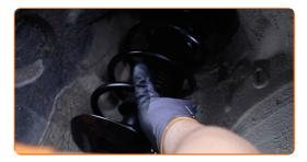
Aparafuse os fixadores superiores do suporte do dispositivo amortecedor. Não o aperte.
