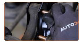
Aparafuse os fixadores que ligam o suporte de suspensão à manga de eixo. Use uma chave combinada nº 18. Use uma chave soquete nº 18. Use uma chave de catraca.
