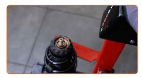
Retire a coluna de suspensão montada.
