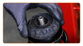
Aperte a porca do suporte do amortecedor da haste do pistão. Use HEX n.º H7. Chave para a porca do amortecedor de 21 mm. Use uma chave de torque. Aperte-o para o torque de 60 Nm.
