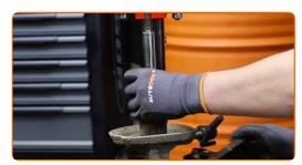
Instale o amortecedor novo no compressor hidráulico de mola.
