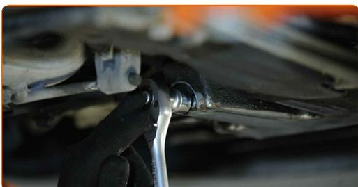
**7** Limpe a área do orifício de drenagem do cárter. Use o spray de limpeza universal.
