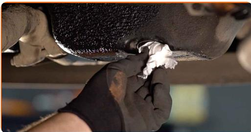
**6** Aparafuse o novo bujão de drenagem e aperte-o. Use uma chave soquete nº 19. Use uma chave de torque. Aperte-o para o torque de 28 Nm.
