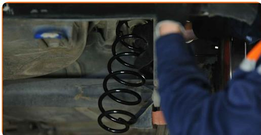
**18** Apoie o eixo de torção da suspensão traseira. Use um macaco hidráulico de caixa de transmissão.
