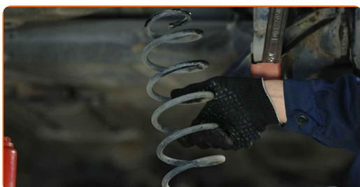
**14** Limpe os locais de montagem da mola espiral. Use uma escova metálica. Use spray WD-40.
