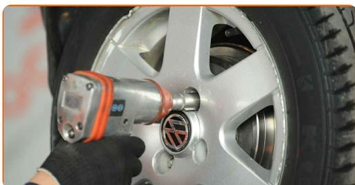
**27** Baixar o carro e trabalhar em ordem transversal, apertar os parafusos das rodas. Use o soquete de impacto para roda #17. Use uma chave de torque. Aperte-o para o torque de 110 Nm.
