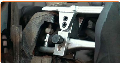
**20** Limpe o fixador do disco de travão. Use uma escova metálica. Use spray WD-40.
