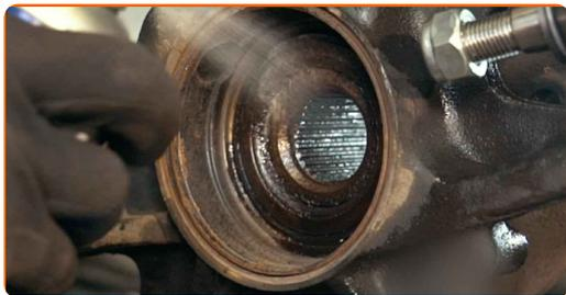
**52** Limpe os assentos de montagem da manga de eixo. Use uma escova metálica. Use spray WD-40.
