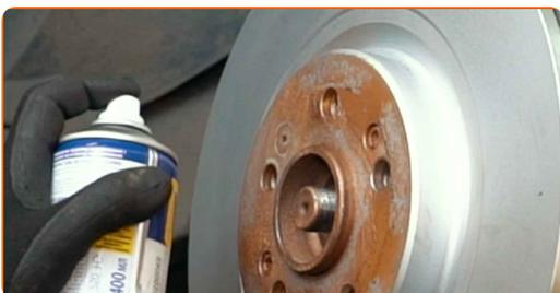
**21** Desaperte a fixação do disco de travão. Use HEX n.º H5. Use uma chave de fenda de impacto.
