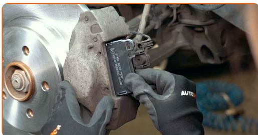
**26** Instale os grampos de retenção das pastilhas de travão. Use um saca-pino. Use um martelo de borracha.
