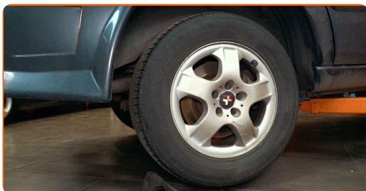
**5** Desaperte os parafusos da roda.
