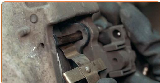
**27** Conecte o sensor do indicador de desgaste das pastilhas de travão.
