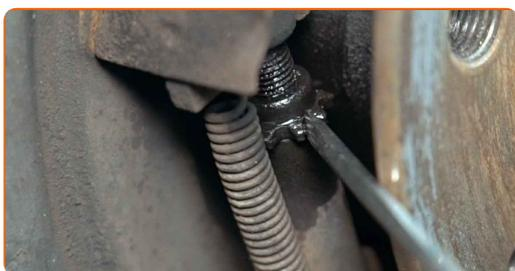
**18** Limpe o cubo. Use uma escova metálica. Use o spray de limpeza universal. Trate a superfície de contacto. Use massa de cobre.
