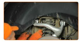
Aperte o fixador frontal, conectando o braço de controlo à subestrutura. Use uma chave combinada nº 18 (2 peças). Use uma chave de torque. Aperte-o para o torque de 120 Nm.
