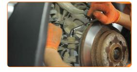
Desaparafuse os fixadores que conectam a bieleta da barra estabilizadora. Use uma chave combinada nº 13.
