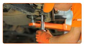
Aperte a fixação do braço inferior. Use uma chave combinada nº 21. Use uma chave soquete nº 21. Use uma chave de torque. Aperte-o para o torque de 135 Nm.
