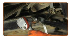
Aperte o fixador traseiro que liga o braço de suspensão à subestrutura. Use uma chave combinada nº 18 (2 peças). Use uma chave de torque. Aperte-o para o torque de 120 Nm.
