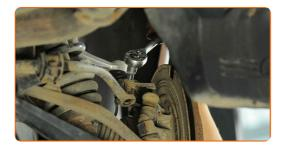
Aparafuse o elemento fixador, que liga o sensor do ABS à manga de eixo traseira. Use uma chave soquete nº 10. Use uma chave de catraca.
