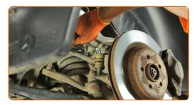
Instale a fixação da haste à barra estabilizadora e aperte-a. Use uma chave combinada nº 13. Use uma chave de torque. Aperte-o para o torque de 28 Nm.
