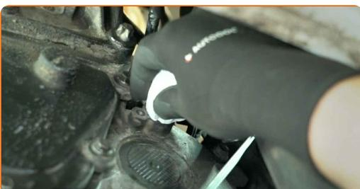
8 Limpar o local de montagem do sensor de posição da árvore de cames. Utilizar spray de limpeza multiusos.
