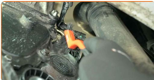
**3** Desligar o conector do sensor de posição da árvore de cames.
