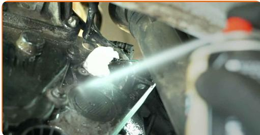
9 Tratar o conector do sensor de posição da árvore de cames. Utilizar um spray para componentes eletrónicos.
