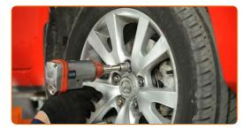
Baixar o carro e trabalhar em ordem transversal, apertar os parafusos das rodas. Use o soquete de impacto para roda #19. Use uma chave de torque. Aperte-o para o torque de 118 Nm.
