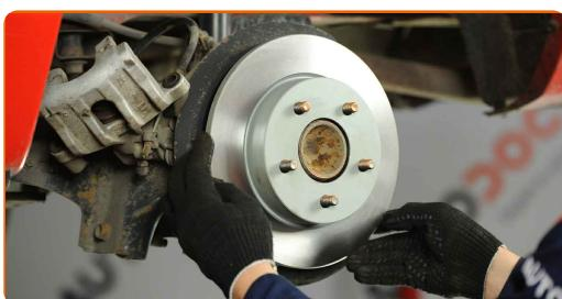
**21** Limpe a braçadeira da pinça de travão de sujidade e poeira. Use uma escova metálica. Utilize um produto de limpeza para travões.
