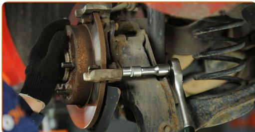
**16** Retire os parafusos de fixação (2 peças).
