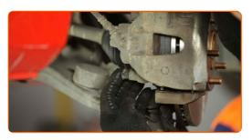
Instale a mola de retenção da pinça do travão. Use alicates de ponta arredondada. Use uma chave de fenda plana.
