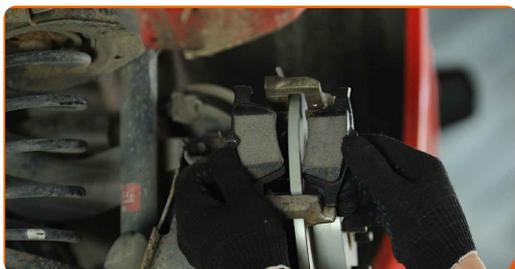
**13** Limpe os fixadores do suporte da pinça de travão. Use uma escova metálica. Use spray WD-40.
