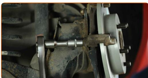
**15** Retire os parafusos de fixação (2 peças).
