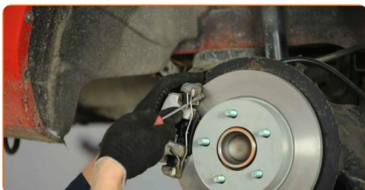
**49** Trate a superfície onde o disco de travão entra em contacto com o aro da roda. Use massa de cobre.
