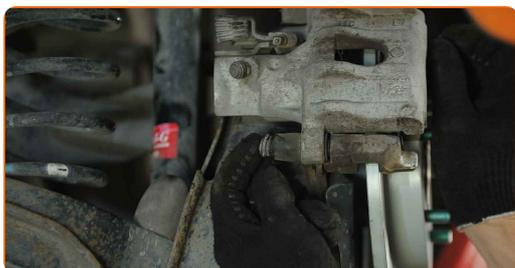
**48** Instale a mola de retenção da pinça do travão. Use uma chave de fenda plana.
