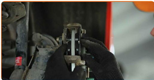
**46** Instale a pinça do travão e fixe-o. Use HEX n.º H7 Use uma chave de torque. Aperte-o para o torque de 30 Nm.
