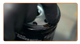
Aparafuse o novo filtro no seu lugar. Use o soquete 74/15-F. Use uma chave de torque. Aperte-o para o torque de 20 Nm.
