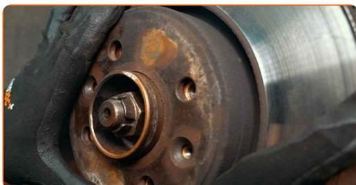
**65** Aperte a fixação do disco de travão. Use Torx T40. Use uma chave de torque. Aperte-o para o torque de 14 Nm.
