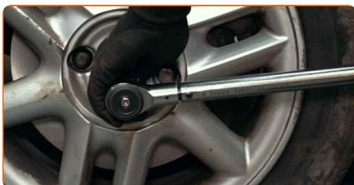
**76** Apertar os parafusos da roda usando um padrão cruzado. Use o soquete de impacto para roda #19. Use uma chave de torque. Aperte-o para o torque de 90 Nm.
