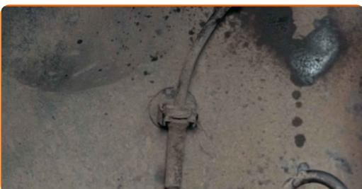
**61** Aparafuse o fixador da junta homocinética. Use uma chave soquete nº 30. Use uma chave de catraca.
