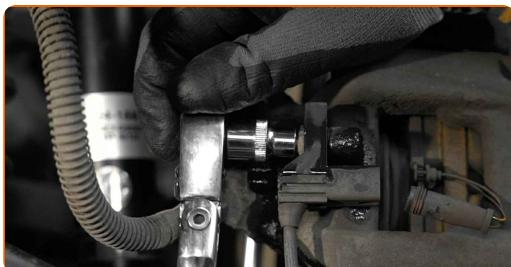
10 Remova o parafuso de fixação.
