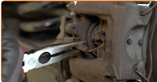
8 Limpe os fixadores da cablagem do sensor de desgaste da pastilha de travão. Use uma escova metálica. Use spray WD-40.
