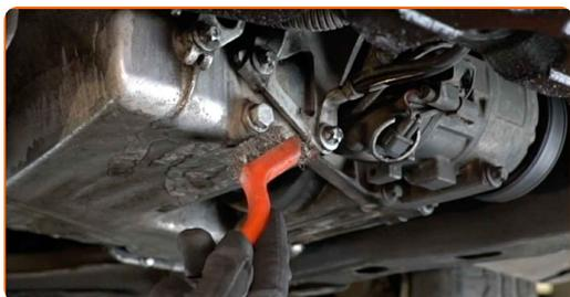
**11** Desaperte o bujão de drenagem. Use uma chave soquete nº 18. Use uma chave de catraca.
