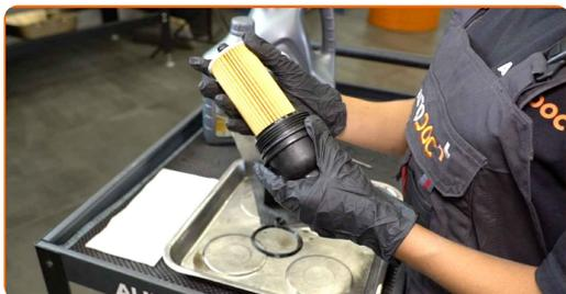
Substituição: óleo do motor e filtro – MERCEDES-BENZ Classe A (W169).
