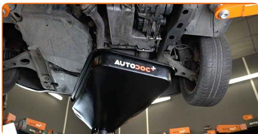
**10** Limpe a área do orifício de drenagem do cárter. Use uma escova metálica. Use o spray de limpeza universal.
