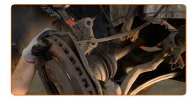
Instale o amortecedor no arco da roda.
