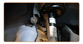
Desconecte os fios do sensor ABS. Desconecte o sensor do indicador de desgaste das pastilhas de travão.
