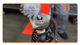
Aperte a porca do suporte do amortecedor da haste do pistão. Use uma chave soquete nº 22. Use HEX n.º H6. Use uma chave de torque. Aperte-o para o torque de 60 Nm.
