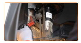
Desaparafuse o fixador que conecta a bieleta da barra estabilizadora à coluna do amortecedor. Use uma chave combinada nº 16.
