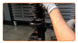
Retire a coluna de suspensão montada.
