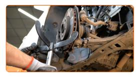
18 Remova o parafuso de fixação.
