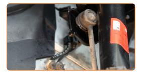
Desaparafuse o fixador que conecta bieleta da barra estabilizadora à barra estabilizadora. Use uma chave soquete nº 16. Use uma chave de torque. Aperte-o para o torque de 60 Nm.
