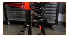
Limpe os assentos de montagem da coluna do amortecedor. Use uma escova metálica. Use spray WD-40.
