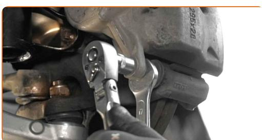
11 Retire os parafusos de fixação.
