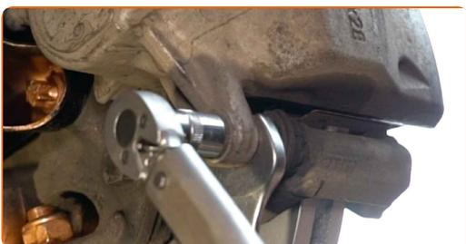
**22** Trate a tampa do sensor de desgaste da pastilha de travão. Use graxa dielétrica.
