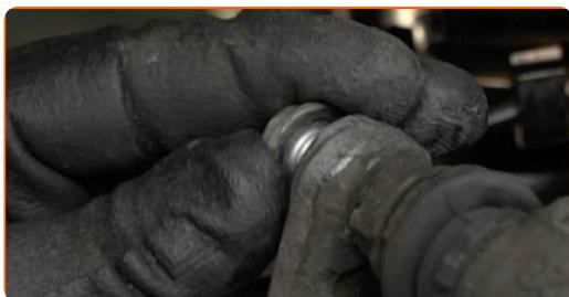
**22** Aperte os fixadores da pinça do travão. Use uma chave combinada nº 17. Use uma chave soquete nº 13. Use uma chave de torque. Aperte-o para o torque de 34 Nm.
