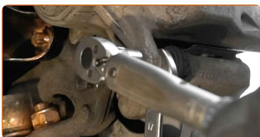
**23** Trate a tampa do sensor de desgaste da pastilha de travão. Use graxa dielétrica.
