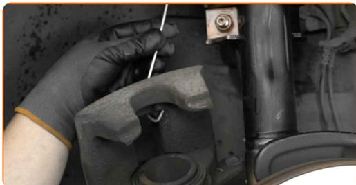
Substituição: sensor pastilha de freio – MERCEDES-BENZ Classe C Coupe (C205). Conselho:
