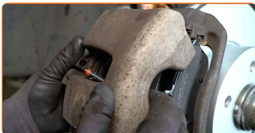
**21** Instale os parafusos de fixação.
