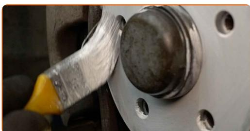
**27** Limpe a superfície do disco de travão. Utilize um produto de limpeza para travões.
