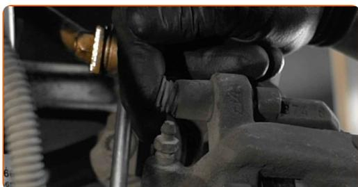
**27** Fixe a cablagem do sensor de desgaste da pastilha do travão.
