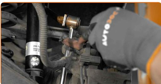
**9** Desaparafuse os fixadores da cablagem do sensor de desgaste da pastilha de travão. Use Torx E10. Use uma chave de catraca.
