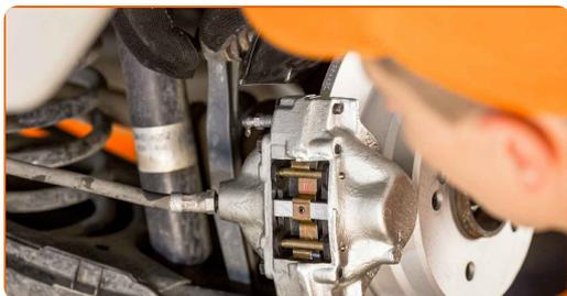
**30** Limpe a sujidade do parafuso da mangueira do travão. Utilize um produto de limpeza para travões.
