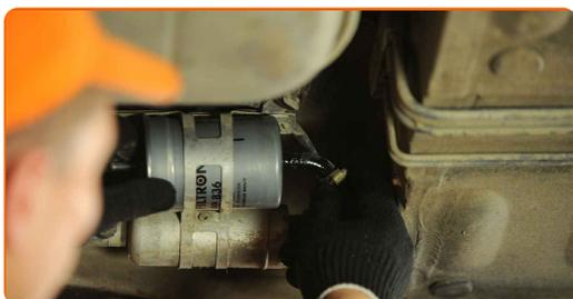
12 Aperte o grampo de fixação do tubo do filtro de combustível. Use uma chave de fenda plana.
