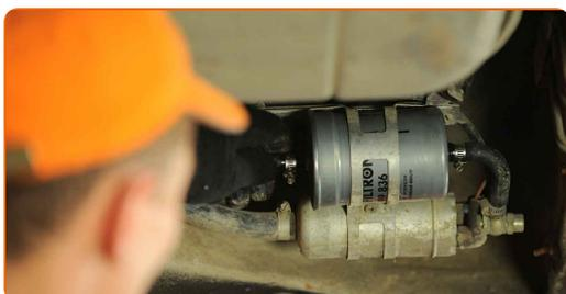
**15** Aperte o grampo de fixação do tubo do filtro de combustível. Use uma chave de fenda plana.
