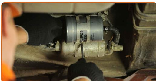
13 Aperte os parafusos de fixação do suporte do filtro de combustível. Use a chave Phillips.
