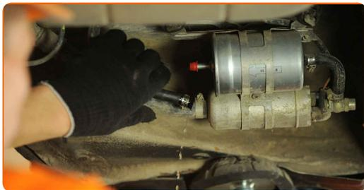
Substituição: filtro de combustível – MERCEDES-BENZ Classe C T-modell (S202). Conselho:
