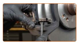
Limpe a braçadeira da pinça de travão de sujidade e poeira. Use uma escova metálica. Utilize um produto de limpeza para travões.
