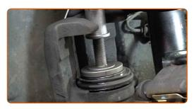
Instale a pinça do travão e fixe-o. Use uma chave soquete nº 12. Use uma chave de torque. Aperte-o para o torque de 25 Nm.
