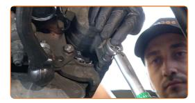
Conecte o sensor do indicador de desgaste das pastilhas de travão.
