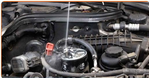
**20** Aparafuse o suporte de montagem do filtro de combustível. Use HEX n.º H5. Use uma chave de catraca.
