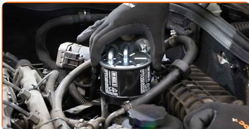
Substituição: filtro de combustível – MERCEDES-BENZ Classe C T-modell (S203). Conselho da AUTODOC:
