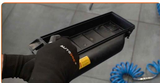
**13** Instale os elementos filtrantes novos. Certifique-se de que as bordas dos filtros encaixam bem na carcaça.
