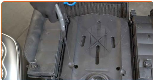
**9** Desaparafuse os fixadores das tampas dos filtros de ar. Use Torx T20. Use uma chave de catraca.
