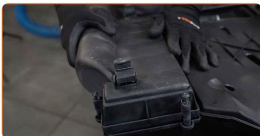
**15** Aparafuse os fixadores das tampas dos filtros de ar. Use Torx T20. Use uma chave de catraca.
