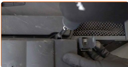
**10** Remova as tampas dos filtros de ar juntamente com os elementos filtrantes.
