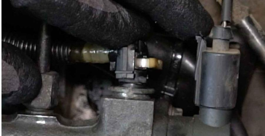
22 Aperte o elemento de fixação da mangueira de combustível. Use uma chave soquete nº E11. Use uma chave de torque. Aperte-o para o torque de 8 Nm.
